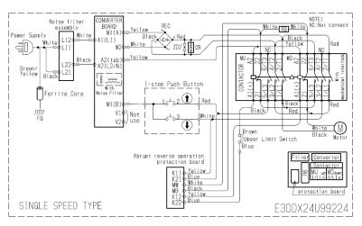
Motor output 600W (WLL 160kg, 240kg, 480kg)
